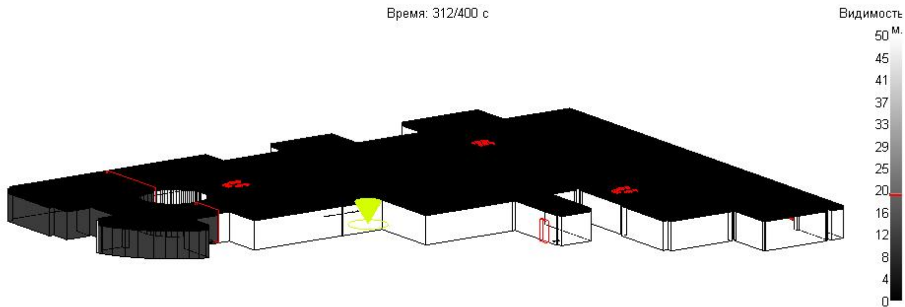
Рис. 24. Сценарий 03. Распространение дыма по автостоянке на -1-м этаже через 312 секунд с момента возникновения пожара
